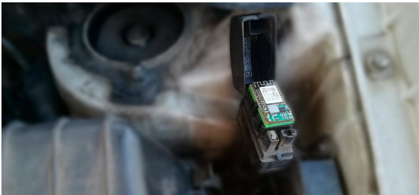
Рис.1 Установленный бескорпусной адаптер Toyota-OBD1 в разъем DLC1 автомобиля Toyota
